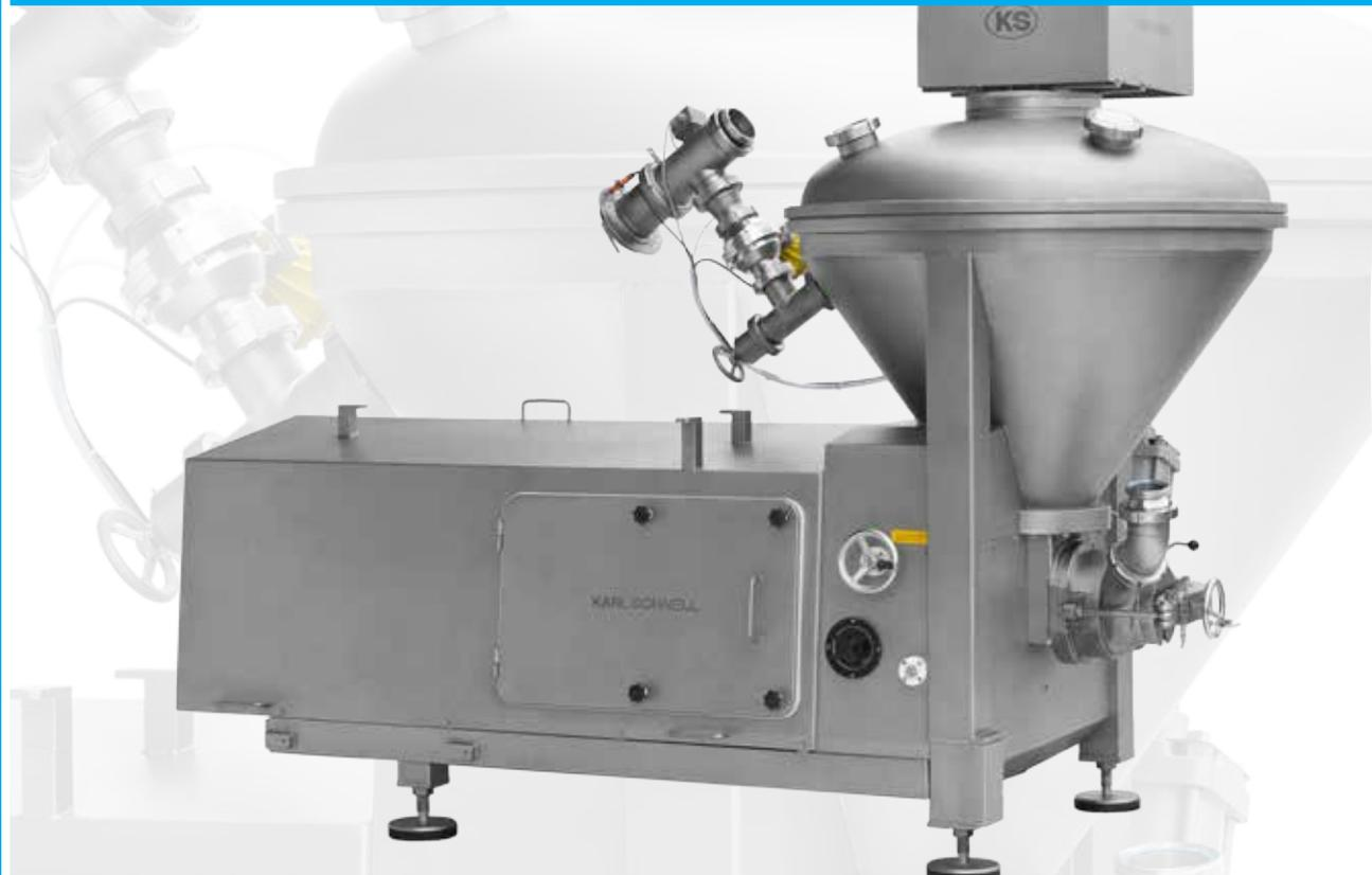
Die leistungsstarken **KS** Feinstzerkleinerer der Baureihe FD 175 DKV und FD 225 DKV mit Vakuumtrichter sind für den Einsatz in kontinuierlich arbeitenden Prozesslinien ausgelegt.
