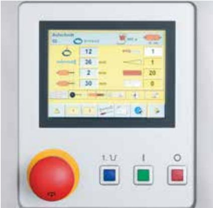
Einfache Maschinensteuerung mit der grafischen Bedienoberfläche EASY TOUCH
